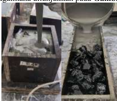
Gambar 1. Proses Penuangan CR-ECC ke Dalam Bekisting
