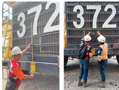
Gambar 3. Riset Ketiga Menggunakan Milimeter Wave Radar V1 dengan Jarak Aktif 50 Meter
