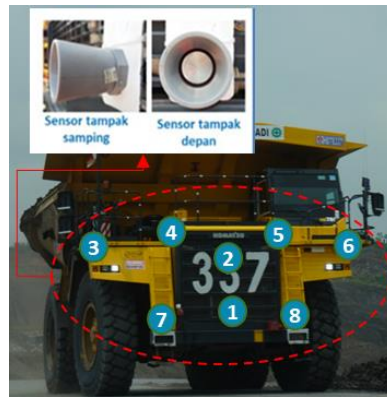
Gambar 1. Percobaan Pertama Menggunakan Sensor Ultrasonik
