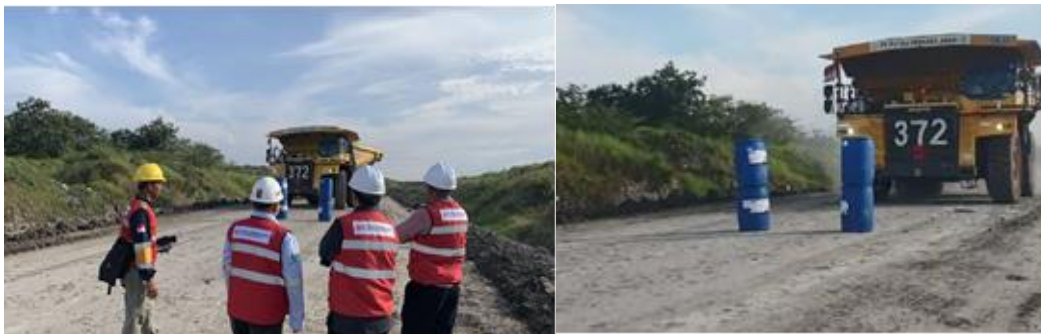
Gambar 4. Riset Keempat Menggunakan Milimeter Wave Radar V2 dengan Jarak Aktif 50 Meter Meter
