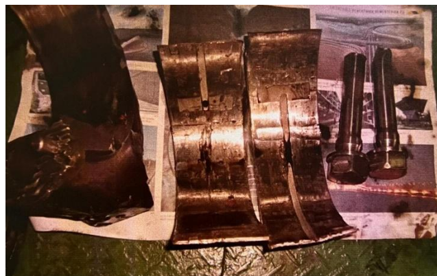
Gambar 8. Crank Pin Bearing Aus
