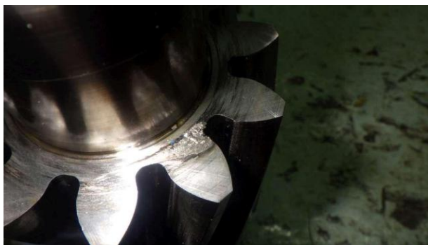
Gambar 5. Gear Pompa LO Aus
