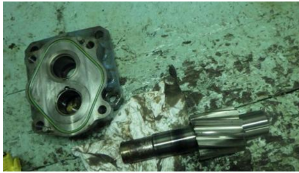
Gambar 6. Komponen Pompa Aus
