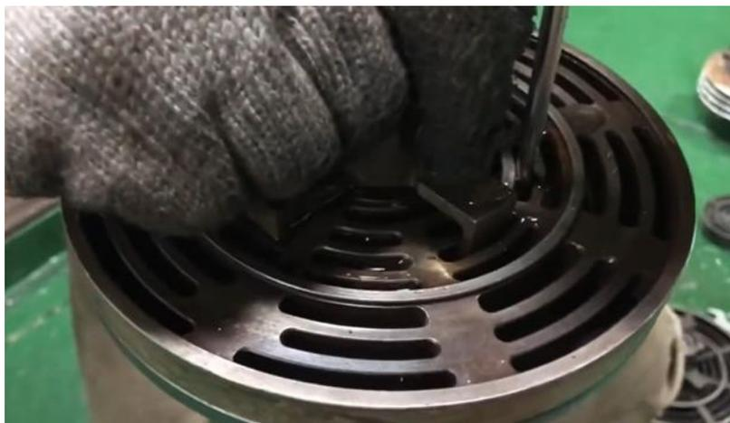
**Gambar 4. Pengetesan Kebocoran pada Katup Kompresor**
